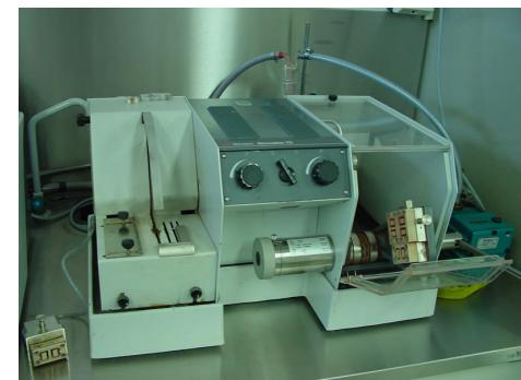
Maquina cortadora y pulidora de muestras minerales
