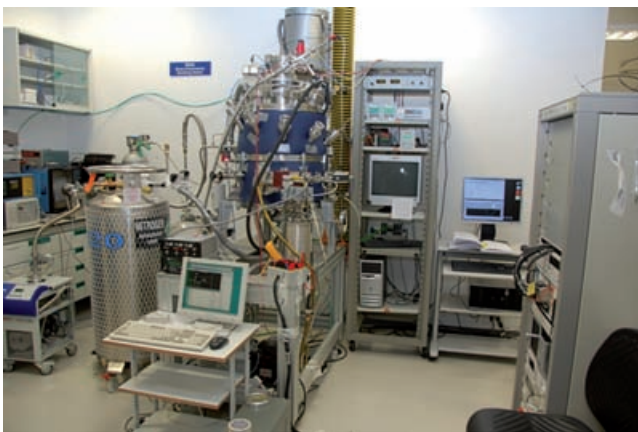
Fig.6. Fotografía de la cámara de simulación MARTE en el centro de Astrobiología (INTA-CSIC).
