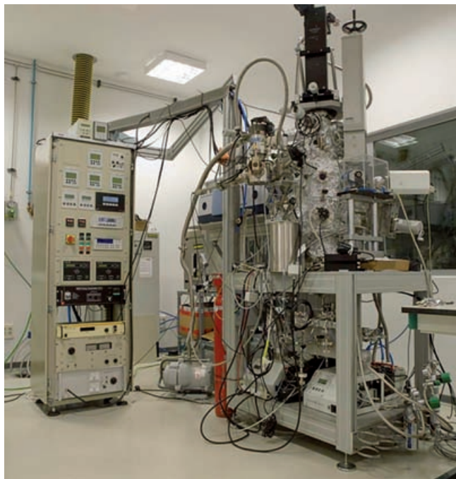
Fig.4. Fotografía de la cámara de simulación ISAC (Interstellar Astrochemistry Chamber) en el centro de Astrobiología (INTA-CSIC).
