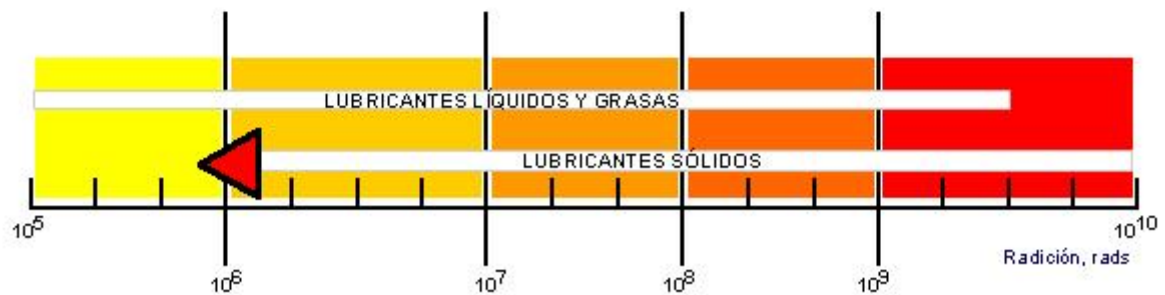
figura 4:rangos de funcionamiento para distintos lubricantes en AMBIENTE RADIATIVO
